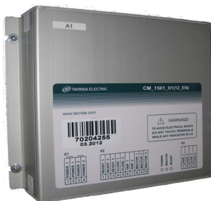
Fot nr 3: Moduł sterujący CM16 wyłącznika z napędem magnetycznym zastosowany w rozdzielnicy MILE .
